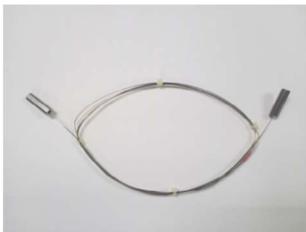
รูปที่ 9 capillary ที่ใช้แทนคอลัมน์
