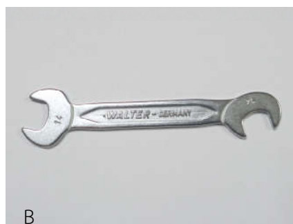
รูปที่ 16 ประแจขนาด \frac{1}{4} นิ้ว (A) และประแจขนาดบาง 14 มม (B)
