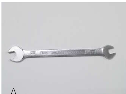
รูปที่ 16 ประแจขนาด \frac{1}{4} นิ้ว (A) และประแจขนาดบาง 14 มม (B)
