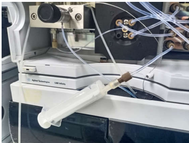
รูปที่ 15 การต่อ Syringe กับปลายส่วนของ degasser
