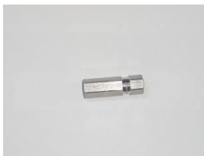
รูปที่ 5 ตัว nut ที่ใช้ต่อแทน column
