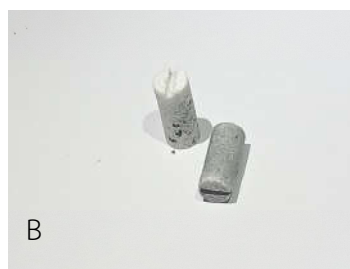
รูปที่ 18 ตัวอย่าง PTFE-frit ที่พร้อมใช้งาน (A) และใช้งานแล้ว (B)
